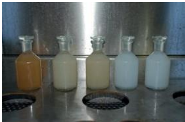
Oksygenflasker tilsatt Winkler A og B. Hvit farge lite oksygen og sterk brun farge mye oksygen. Foto: Kjemilaboratoriet, Havforskningsinstituttet.
